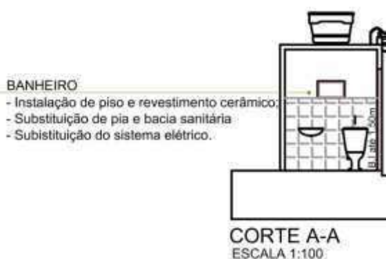
Imagem 227: Visão do projeto com substituição das louças do banheiro.
