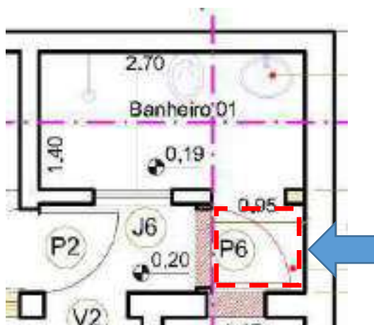
Imagem 174: Localização de instalação do forro de PVC branco no banheiro 01.
