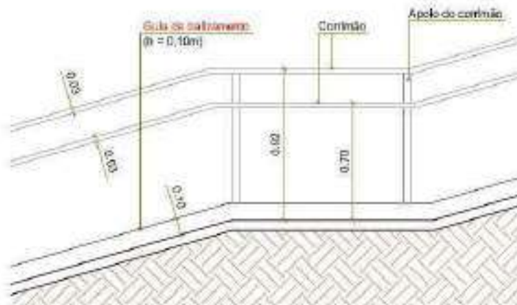
Imagem 20: Detalhe da instalação do corrimão (ver projeto arquitetônico).
