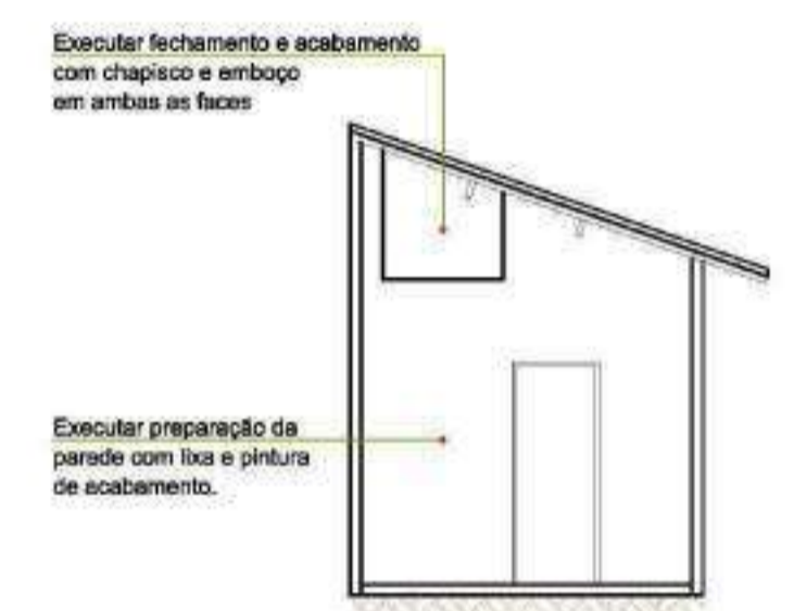
DETALHE 2: REPAROS NA PAREDE 4 ESCALA 1/75 PROPOSTA
