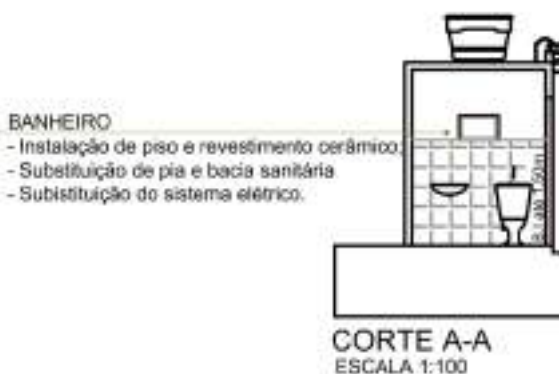
Imagem 225: Visão do projeto com indicativo de aplicação de revestimentos cerâmicos.
