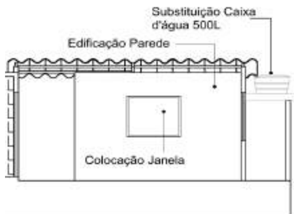
Imagem 221: Visão interna do projeto com o local para janela.
