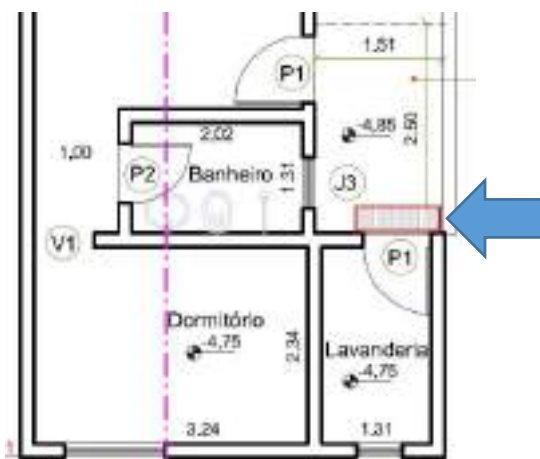
Imagem 34: Localização de instalação da canaleta e grelha.
